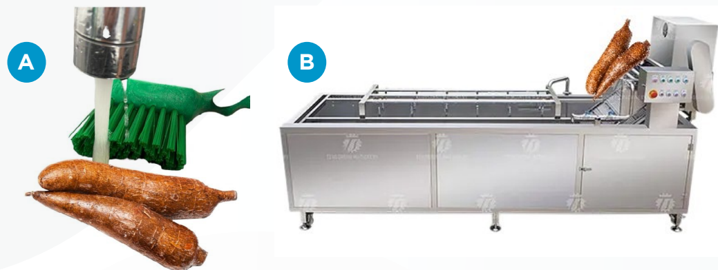
Figura 8. Etapa de lavado de las yucas. a. Lavado manual, b. Lavado automático.
