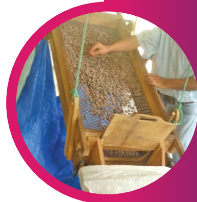
Figura 26. Selección de granos por tamaño empleando zarandas
