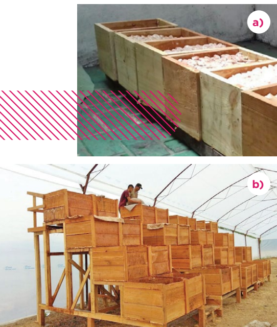
Figura 8. Sistema de fermentación en cajones: a) Cajones lineales sencillos (Finca CATIE, Turrialba) b) Cajones tipo escalera (Centro de acopio Nahua, Upala)
