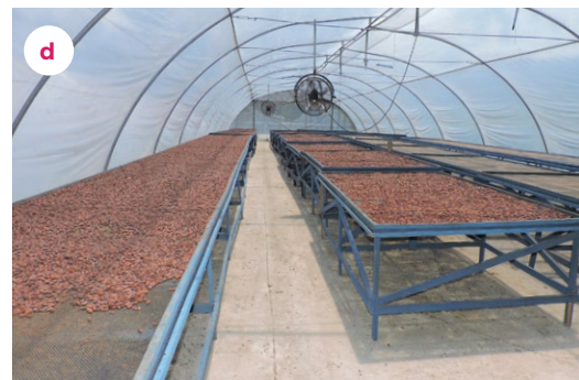
Figura 21. Diferentes modelos de secador tipo túnel con camas levantadas
