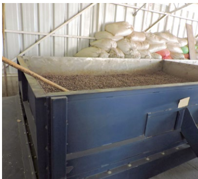
Figura 25. Secador artificial de cacao tipo Samoa
