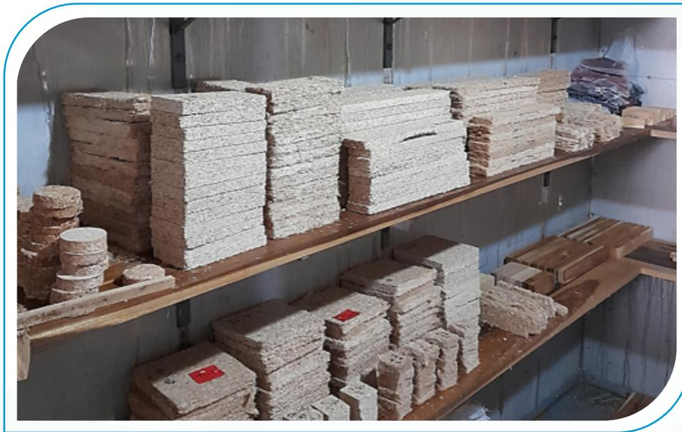
**Figura 53.** Muestra de los tableros realizados en laboratorio considerando diferentes mezclas de madera de Melina y fibra de Abacá.
