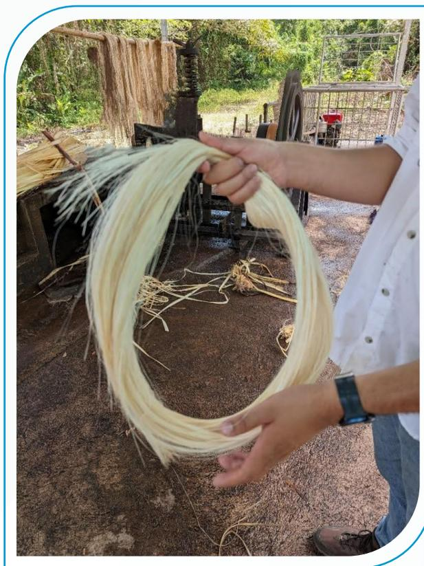
**Figura 9.** Detalle y aspecto de la fibra recientemente procesada mediante la máquina Spindle.
