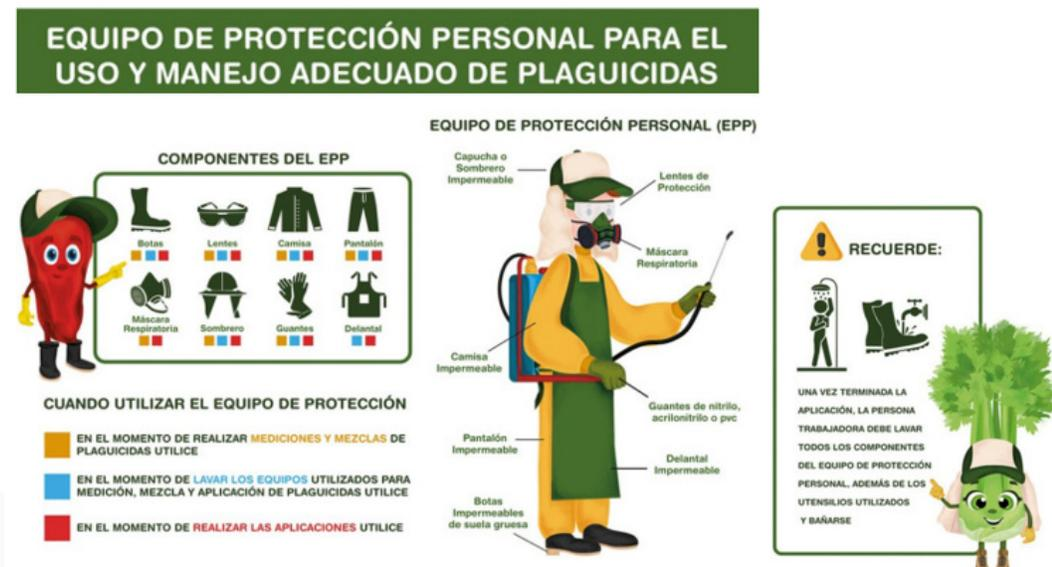
**Figura 49.** Equipo de protección personal recomendado para el uso y manejo adecuado de plaguicidas.
