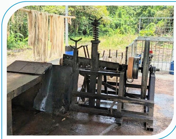
**Figura 39.** Detalle de una máquina tipo Spindle.
