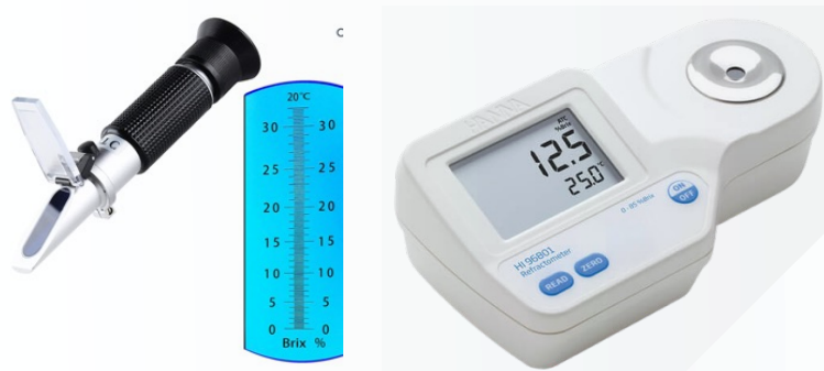
Figura 15. Ejemplos de refractómetro y brixómetro utilizados para la medición de los grados Brix en pulpas.
