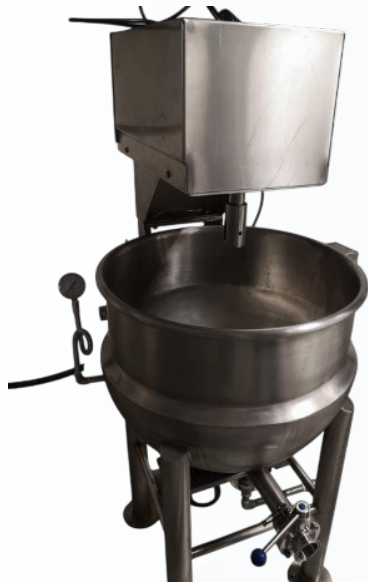
Figura 12. Marmita utilizada para la etapa de pasteurización de la pulpa de mango.
